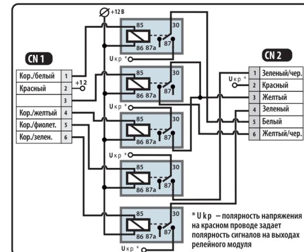
ПРИМЕР ПОДКЛЮЧЕНИЯ РЕЛЕЙНОГО МОДУЛЯ SCHER-KHAN M1
