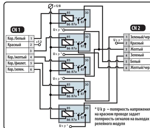
ПРИМЕР ПОДКЛЮЧЕНИЯ РЕЛЕЙНОГО МОДУЛЯ SCHER-KHAN M1
