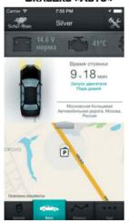
На вкладке «Авто» размещены элементы, позволяющие осуществлять контроль за состоянием автомобиля в реальном масштабе времени\*\*. Фактически, указанная вкладка сочетает в себе элементы дисплея брелока, приборной панели автомобиля и навигационного прибора. Пользователь имеет возможность одновременно контролировать состояние эксплуатационных параметров:
