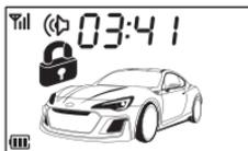
MOVICAR 2 управляет работой двигателя в режиме автозапуска: выключает его в случае тревоги или по окончании времени автозапуска. Для поездки на автомобиле Вы должны взять управление двигателем на себя. Для этого выключите режим охраны, сядьте в автомобиль. Если автомобиль оборудован замком
