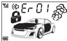
Если не закрыты двери, капот, багажник, включено зажигание, не включен стояночный тормоз, нажата педаль тормоза, селектор передач не в положении **P** (Parking), на брелок придет сообщение с номером ошибки, вызвавшей отказ (стр. 72).
